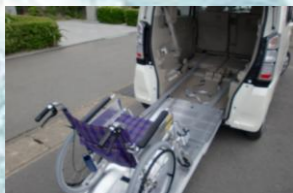
電動ウインチで車椅子を 車内へ乗り入れます。
